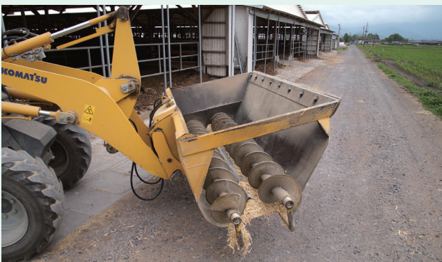
TMRの給餌は特注でスクリューを装着したショベルカーで行い、省力化を図っている
