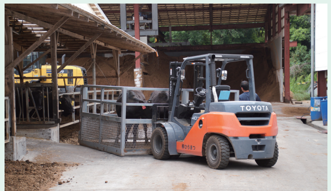
広大な牧場かつお産なども毎日のことのため、牛の移動も省力的に。フォークリフトに対応した特注のケージで運んでいる
