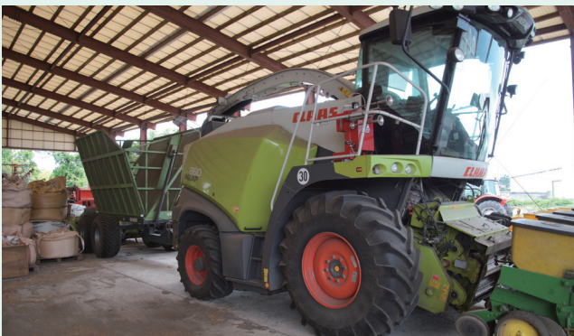
本社だけで約120haのデントコーン畑を有するなど飼料作りに力を入れており、飼料の安定と機能性向上のための投資は惜しまない。こちらのハーベスターは7000万円の代物だが、収穫時にデントコーンの子実裁断とすり潰しをすることで、発酵TMRの消化性向上に寄与する
