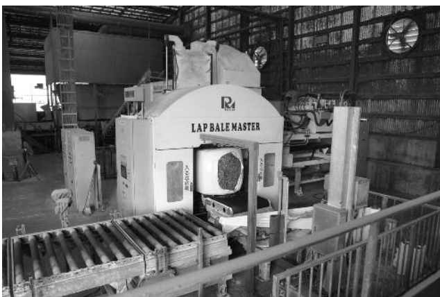
TMRセンターのラップベールマシン。右手のシリンダー部分でTMRを強烈に圧縮し、ラッピングしていく
